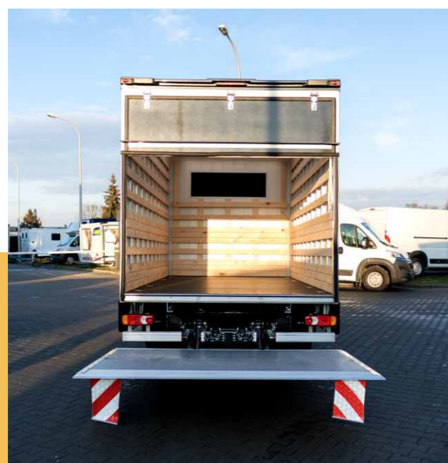
LAMBox transportowy z opuszczanym na silownikach trapem. Zabudowa może być także wyposażona w windę 750 kg.
